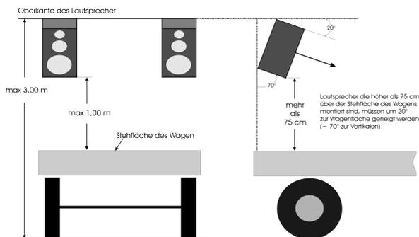
Abb.2. Bauhöhen und erforderliche Abstrahlwinkel
